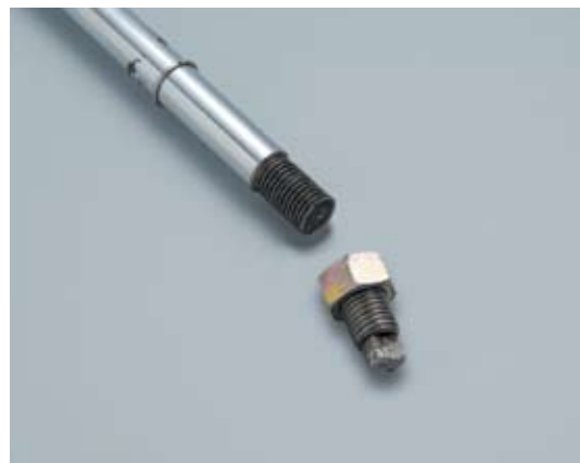
Lom navoja vrha klipnjače
